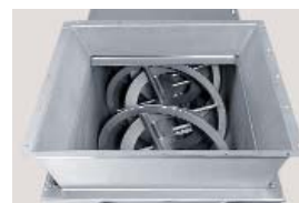
▲ Einlauf des Chargenmischers
