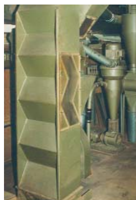
▲ Kaskadensichter nach dem Umluftprinzip in einer Gewürzmühle
