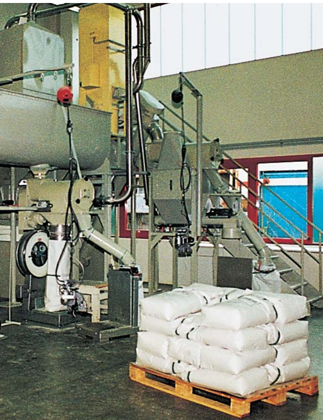
▲ Kaskadensichter nach dem Umluftprinzip in einer Gewürzmühle
