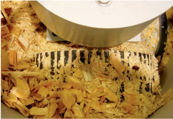
Zermahlung der Holzschnitzel im Kollergang
