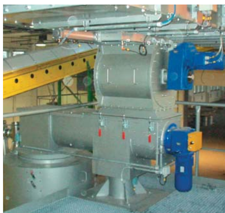
Dosierung zur Pelletpresse
