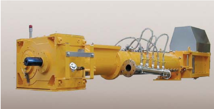
Extruder OEE Standardausrüstung mit Heiz- und Kühlmantel
