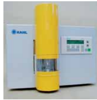
Der Kahl-Pellet Härte tester dient der Qualitätskontrolle
