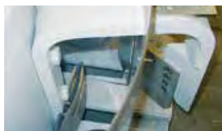
Бегунковая головка с направляющими для точного разделения продукта
