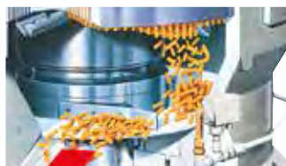
Обрезное устройство для гладкой кантовки и уменьшения количества мелкой фракции
