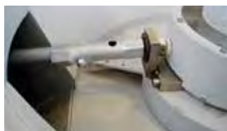
Упор бегунковой головки для оптимальной регулировки бегунков и матрицы
